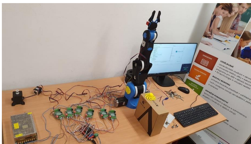
Robotická ruka sestavená z dílů vytištěných na naší 3D tiskárně
